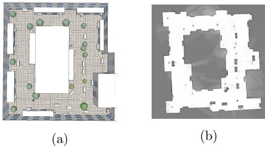
図1 作成した仮想環境: (a) 仮想環境をシミュレータ画面で俯瞰で表示したもの (b) SLAM モジュールを使って作成した全体マップ
