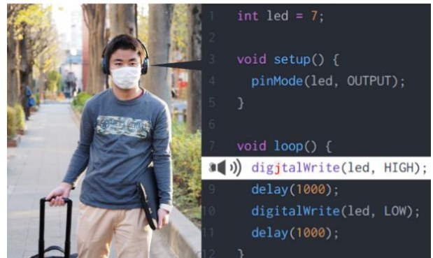
図1 口の表情を識別しソースコード読み上げを操作することでバグを聴覚情報の提示で発見を行っている様子
